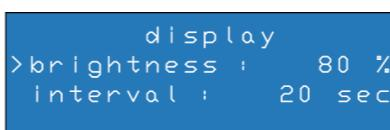
在显示屏子菜单中，您可以设置进行操作时背光的亮度和结束最后操作后背光仍持续多长时间。
