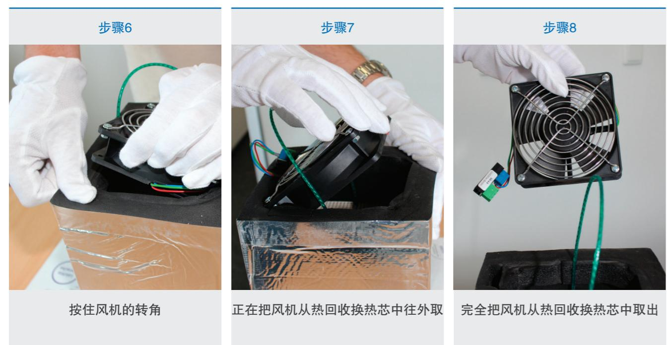
通常使用真空吸尘器就足够达到清洁的目的。如果是更严重的污染，热回收换热芯及其外包隔热层(没有风机)可以用温水冲洗。热回收换热芯必须完全干燥后才能重新安装。外包隔热层具有防水功能,只是表面会变得潮湿。
