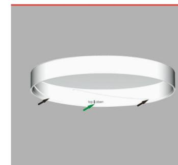
在圆型内风罩面板里侧，在顶部有“top”指示商标（绿色箭头）。
