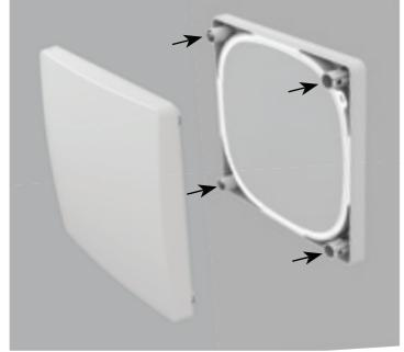
保持面板上的商标在右下角，将面板同样安装在底座的连接杆上。轻推面板向墙面方向，直到内风罩关闭，然后把面板向外拉到打开位置。期间可以感觉卡扣达到合适位置，此时就可以任意调整内风罩方向。
