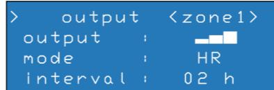
除了7天设定的设置为预先设定外，其他都可以根据当前的情况手动设置“output”输出菜单。对于每个“zone”区域都可以分别实现单独手动控制。要求在主屏幕上操作。
